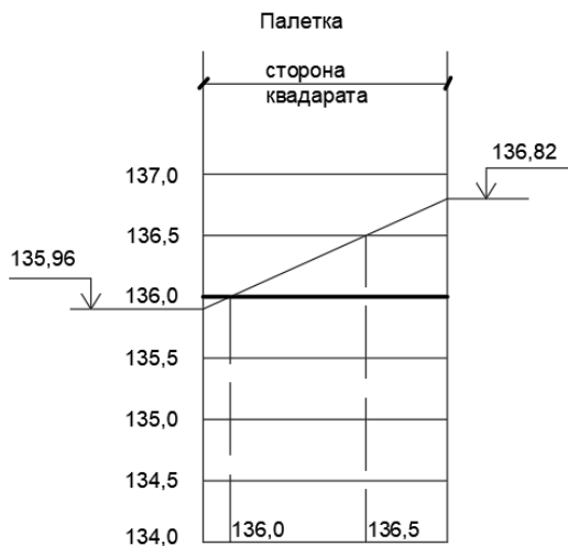
Рис. 6. Графическое интерполирование горизонталей стороны квадрата с вершинами 2а-2б
